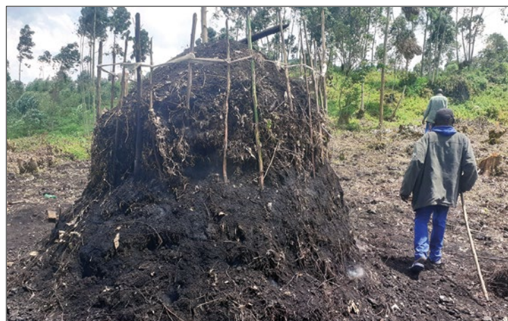
Photo 1 : Meule en cours de carbonisation dans le bassin d'approvisionnement en bois-énergie de la ville de Goma (G. Imani, 2021)
