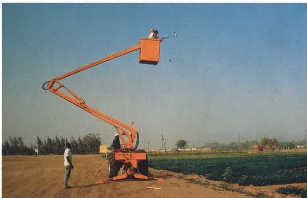
Enregistrement de la signature radiométrique d'un sol dénudé (à gauche) ou en culture irriguée (à droite) à l'aide d'un radiomètre Cimel, manipulé à 6 m du sol.
