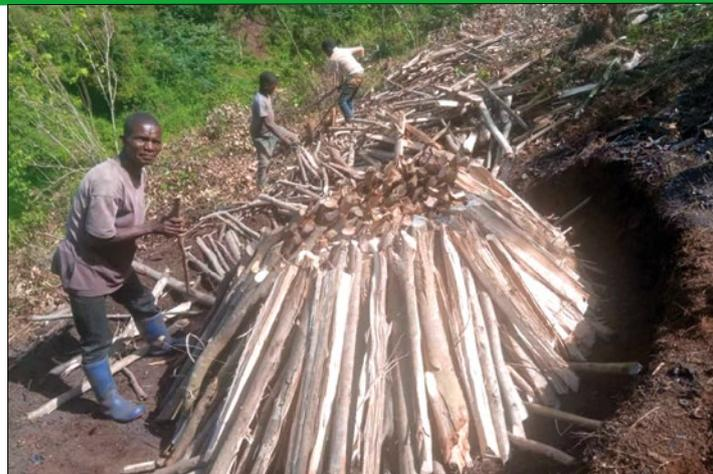
Photo 5 : Construction d'une meule pour la production de charbon de bois (G. Imani, 2021)
